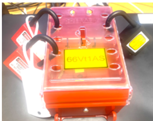
Eksempel: To driftsmessige sikringer på objektet og en personlig lås (LFS)
