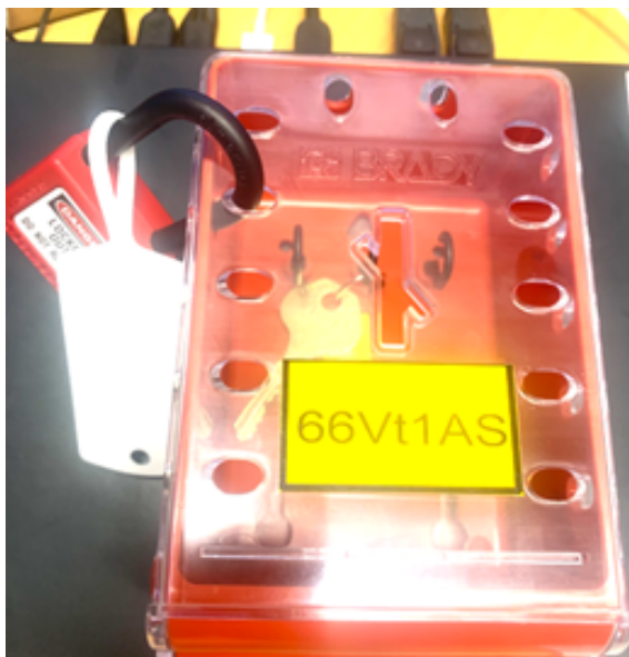
LOTO-boks sikring etablert for objekt
