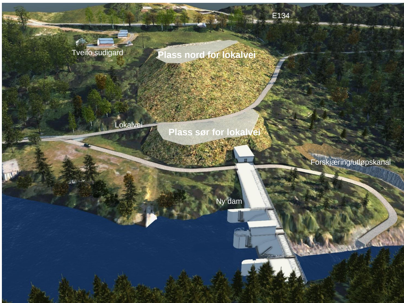
Figur 3.12 Illustrasjon viser planlagte nye plasser for grunneier, samt ny dam og forskjæring/utløpskanal med permanent adkomstvei.
