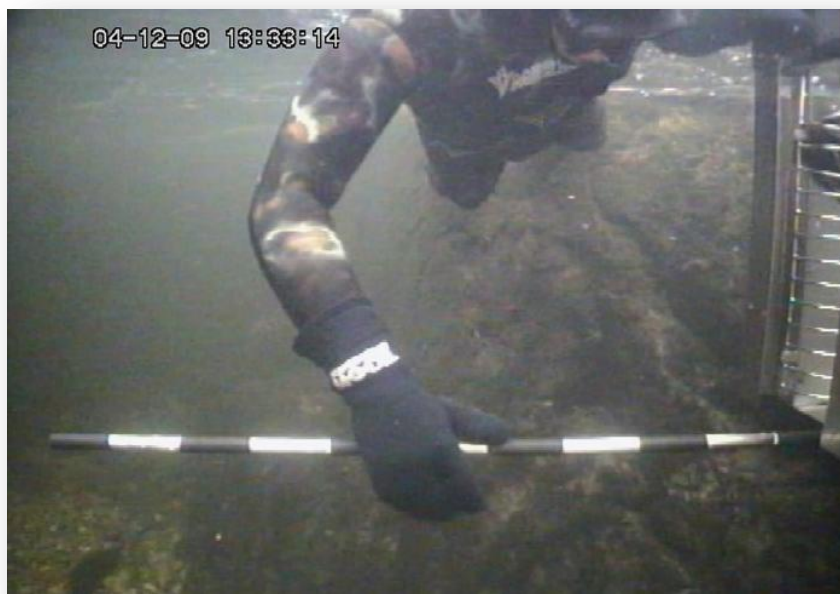
Figur 4. Utløpet av den mekaniske fisketelleren med målestav der hver tiende cm er avmerket
